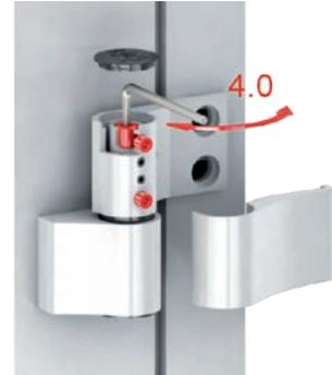
Avant de régler les paumelles, retirez le cache de la paumelle et desserrez les vis de fixation comme indiqué sur l'image. De même, après le réglage, fixez-les à nouveau.
