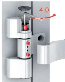
Avant de régler les paumelles, retirez le cache de la paumelle et desserrez les vis de fixation comme indiqué sur l'image. De même, après le réglage, fixez-les à nouveau.
