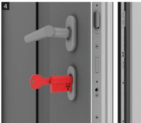
**5** Mesurez les dimensions du cylindre. Le cylindre se mesure du centre du trou vers l'extérieur.
